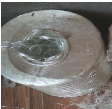
Fig. 3. FRPs a) GFRP strings, b) GFRPS stirrups.
